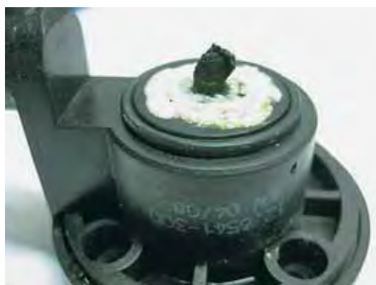
Рис. 49. Разрушение измерительного электрода.
