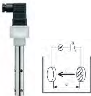
Рис. 20 Общий вид и принцип действия ячейки для кондуктометрических измерений
