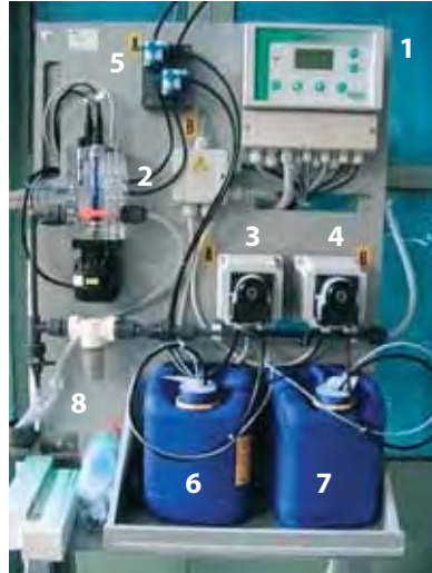
Рис. 120. Компактная система для измерения общего хлора 314 – 310
