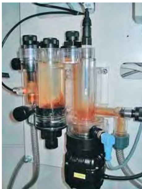
Рис. 27 Воздействие повышенного содержания железа в артезианской воде на состояние измерительной ячейки АQC D-1
