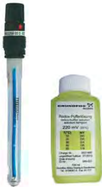
Рис. 29 Электрод Redox/AS 313-05 для измерения ОВП и калибровочный буферный раствор
