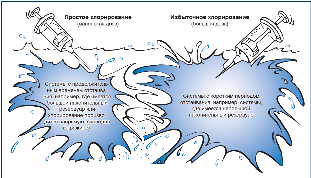
Рис.38 Простое и избыточное хлорирование
