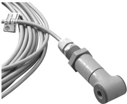
Рис. 31 Измерительная ячейка для индукционных измерений электропроводности
