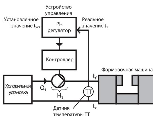
Рис. 8 Регулирование по постоянной температуре
