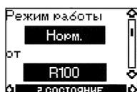
В этом окне отображается текущий рабочий режим (Останов, Мин., Нормальный или Макс.). Кроме того, здесь отображается, как был введен этот режим (с пульта R100, с панели управления насоса, с помощью шины связи и т. д.).
