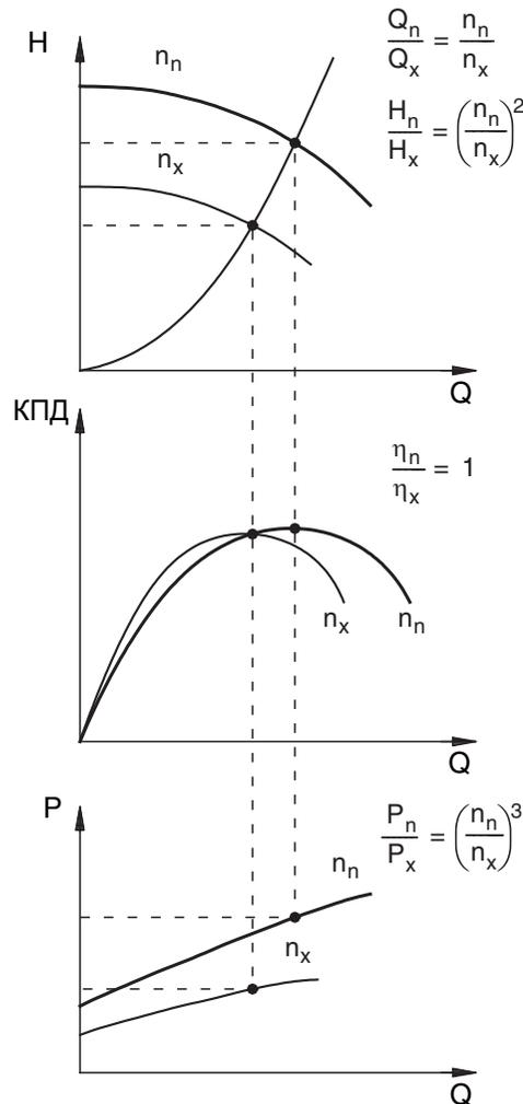
Рис. 1 Зависимость характеристик насоса от числа оборотов электродвигателя
