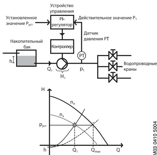
Рис. 7 Регулирование по постоянному давлению
