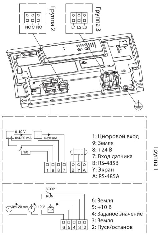
Рис. 37 Схема подключения
