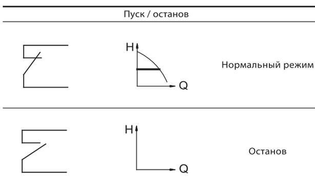
С помощью R100 для цифрового ввода может быть выбрана одна из следующих функций:
