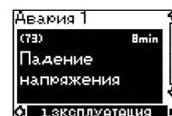
Если сработала аварийная сигнализация, то в окне появится индикация последних пяти аварийных сигналов. «Протокол неисправности 1» показывает последнюю неисправность.
