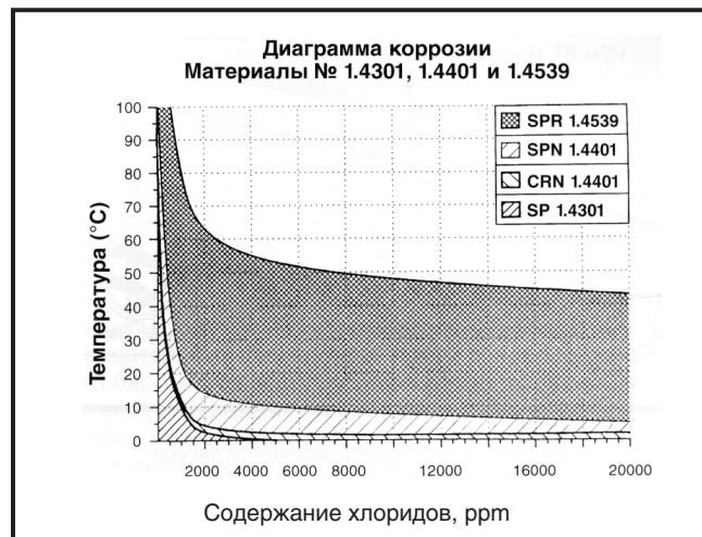
Например, при температуре подземных вод до 10°C можно применять насос в стандартном исполнении (сталь 1.4301) в том случае, если содержание хлоридов в воде не превышает 1000 частей на миллион. Сталь типа N можно использовать при содержании хлоридов до 5000 частей на миллион. При температуре морской воды до 40°C нужно применять сталь типа R, если содержание хлоридов не превышает 20000 частей на миллион.
