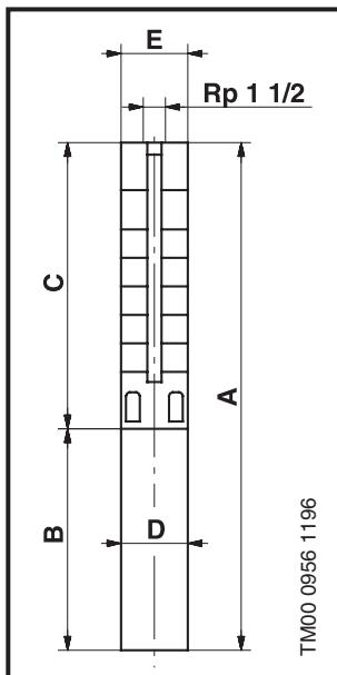
Насосы моделей SP 5A-75 и SP 5A-85 устанавливают в кожухе с присоединением R 1½.
