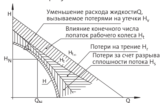
Рис.4 Уменьшение характеристики Q/H ( H ) насоса по сравнению с теоретическим напором насоса H_{t\infty} .
