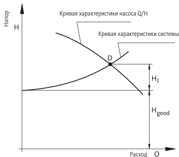
Рис.60 Эксплуатационный режим работы насоса (D) определяется путем наложения кривой характеристики насоса на кривую характеристики системы. Величина полного напора есть сумма геодезического напора ( H_{\text{geod}} ) и потерь в трубопроводе ( H_j ).
