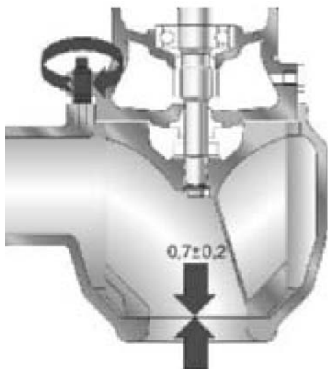
Рис.35 Система регулировки зазора всасывания с помощью трех установочных винтов
