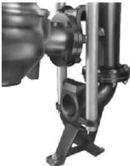
Рис.44 Автоматическая трубная муфта фирмы GRUNDFOS. Насос надежно удерживается на месте посадки своим весом. Точно обработанные контактные поверхности и резиновые уплотнительные кольца обеспечивают герметичность соединения. Зазор между направляющими кlyками и трубами обеспечивает беспрепятственный подъем насоса даже в случае загрязнения.
