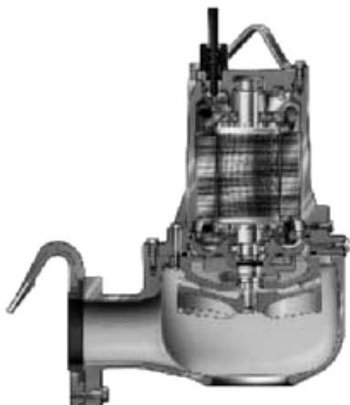
Рис.15 Поперечный разрез погружного насоса мощностью 2,4 кВт фирмы GRUNDFOS, на котором изображены детали насоса и двигателя. Насос снабжен специальными направляющими кляками для соединения с установленной на дне резервуара на плите-основании системой автоматической трубной муфты, обеспечивающая простоту установки и демонтажа насоса.
