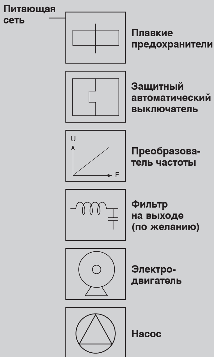
Компоненты типового монтажа
