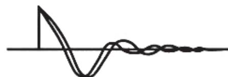
Форма сигнала дефектной обмотки
