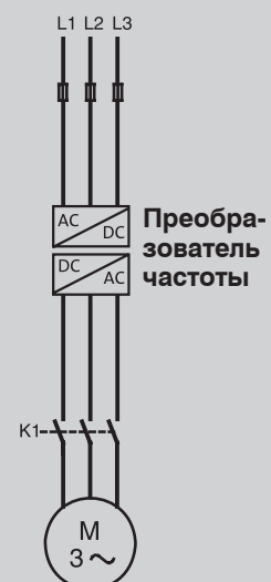
Схема электрических соединений электродвигателя, работающего с преобразователем частоты
