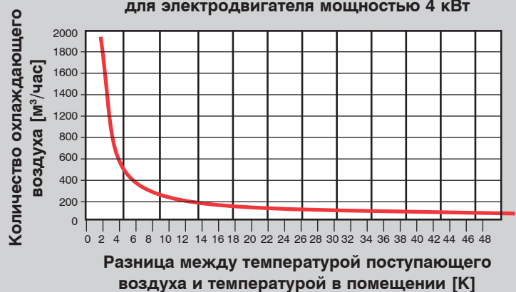
Необходимый приток воздуха для электродвигателя мощностью 4 кВт
