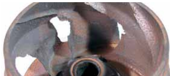
Эрозионная коррозия чугунного рабочего колеса
