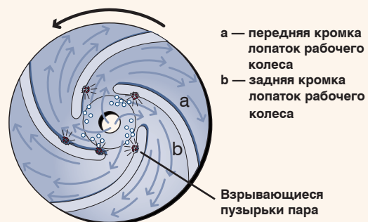
Рис. 2.2.9: Взрыв кавитационных пузырьков на задней стороне лопаток рабочего колеса
