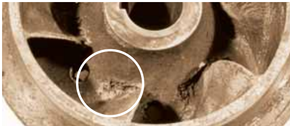
Кавитационная коррозия бронзового рабочего колеса
