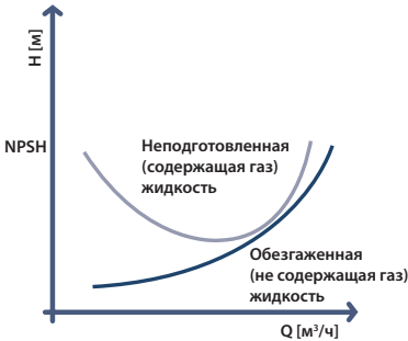
Рис. 2.2.15: Типичная характеристика NPSH для жидкостей, содержащих газ и жидкостей, из которых газ удален
