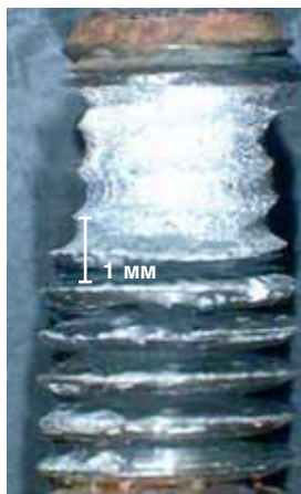
Щелевая коррозия стали 1.4462 (SAF 2205)
