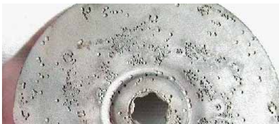
Точечная коррозия стали 1.4401 (AISI 316)
