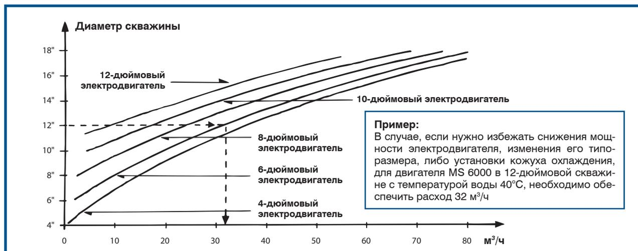
Рис. 24. Необходимый расход насоса для обеспечения охлаждения погружного электродвигателя при максимально допустимой температуре рабочей жидкости, пиковой нагрузке и скорости потока обтекания 0,15 м/с
