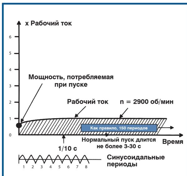
Рис. 23. Пуск электродвигателя посредством преобразователя частоты
