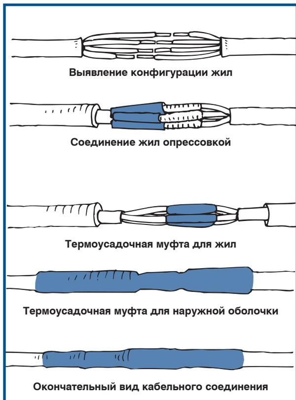
Рис. 35. Термоусаживаемая трубка
