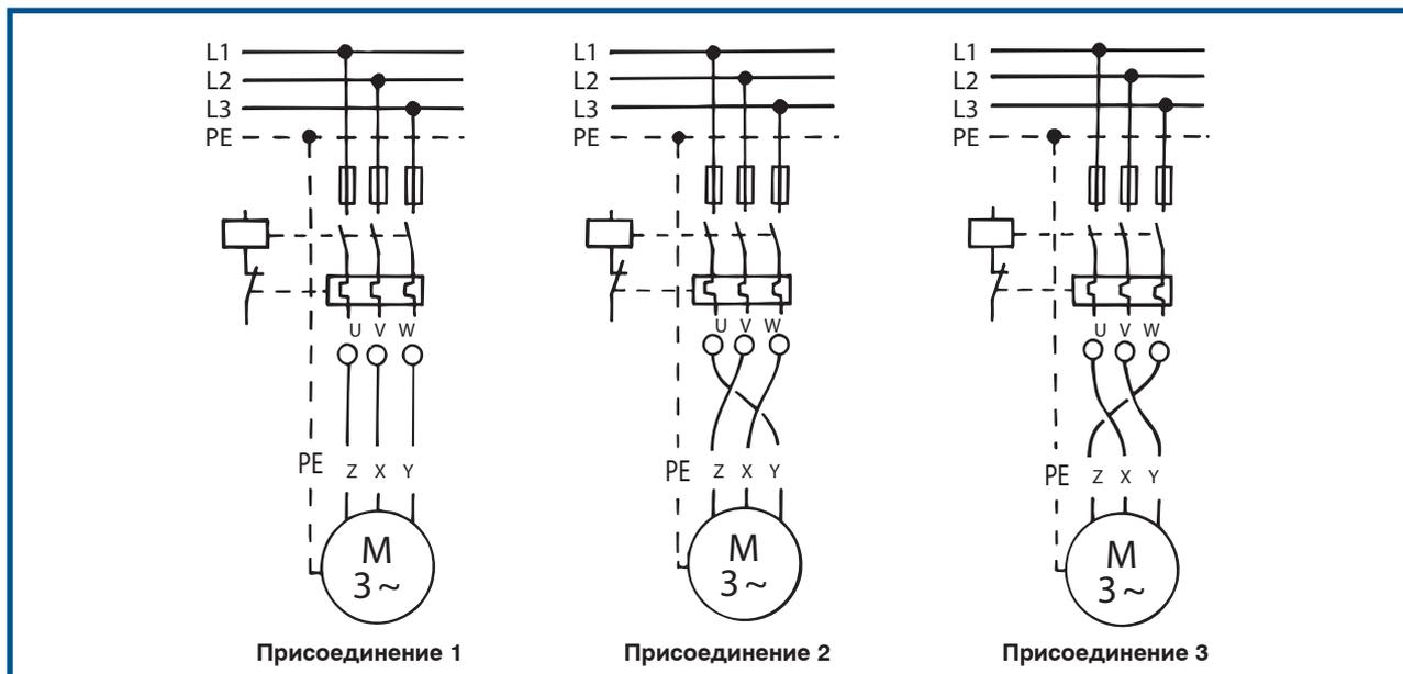
Рис. 32. Коррекция асимметрии тока у трехфазного погружного электродвигателя 3 · 400 В, 50 Гц, 30 А
