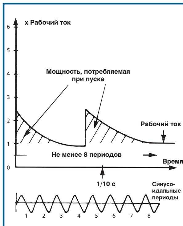
Рис. 21. Пуск электродвигателя через пусковой трансформатор
