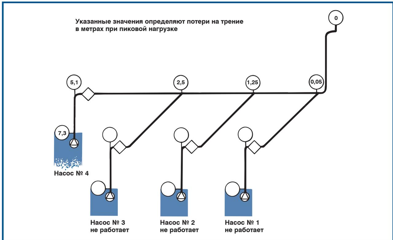
Рис. 14. Потери на трение при эксплуатации только насоса № 4
