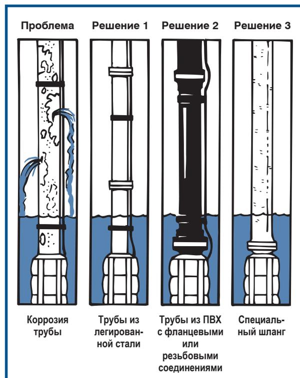
Рис. 40. Коррозия труб и способы ее предотвращения
