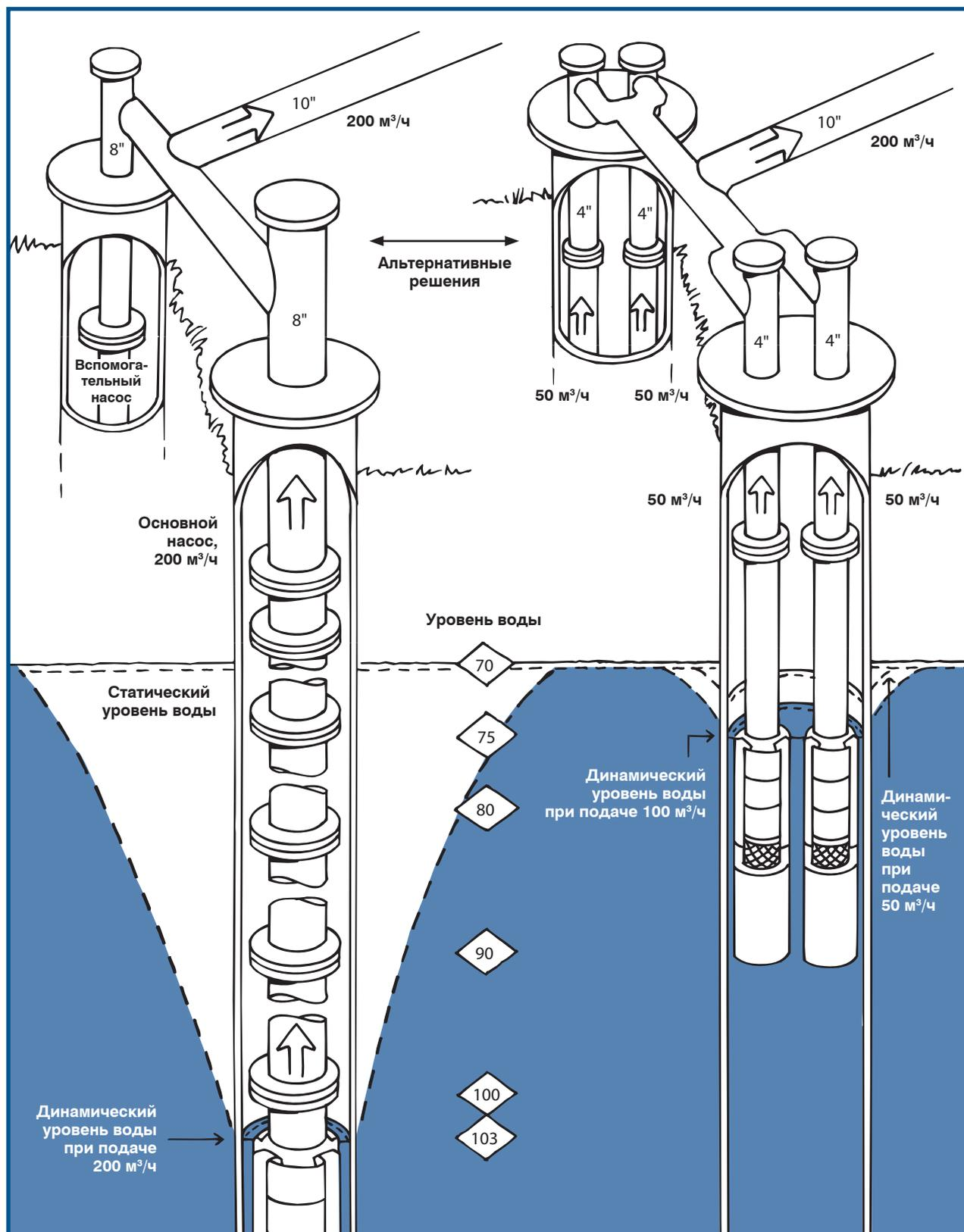
Рис. 16. Понижение уровня воды в зависимости от расхода
