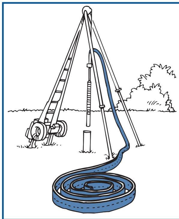
Рис. 43. Установка водоподъемной трубы по системе Well Master/Foraduc
