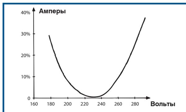
Рис. 31. Дополнительное потребление тока при колебаниях напряжения
