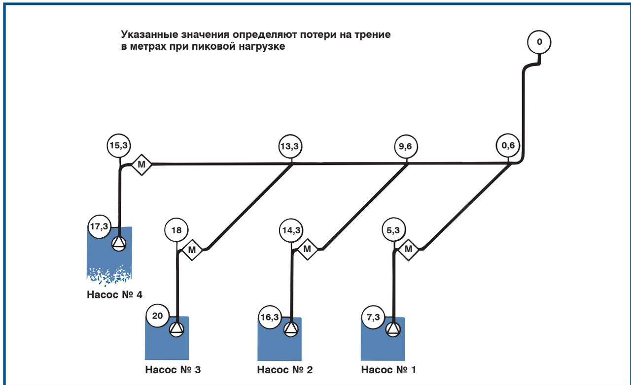
Рис. 11. Потери на трение в соответствии с ожидаемым  $Q_{\text{макс}}$ .
