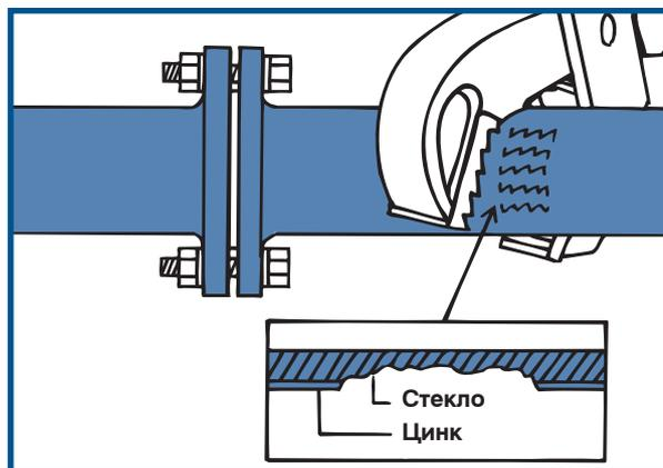
Рис. 5. Электрохимическая коррозия
