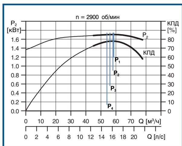
Рис. 15. Потребляемая мощность ( $P_2$ ) при базовой нагрузке насоса № 4
