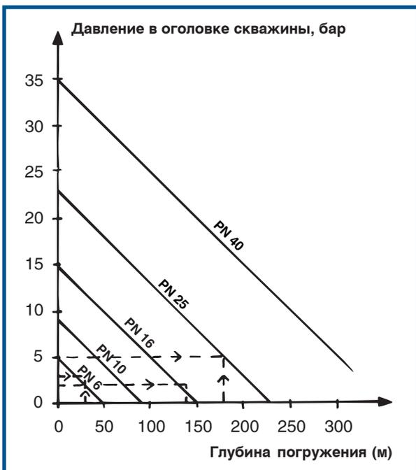
Рис. 39. Зависимость требуемого уровня давления, выдерживаемого трубами, от глубины погружения и фактического давления
