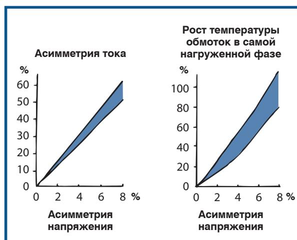
Рис. 33. Зависимость между асимметрией тока, напряжения и температурой
