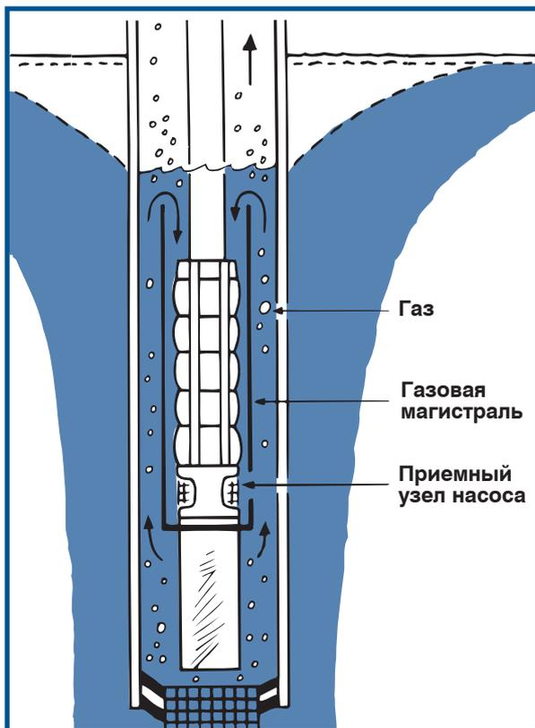
Рис. 55. Устройство для дегазации выкачиваемой из скважины воды
