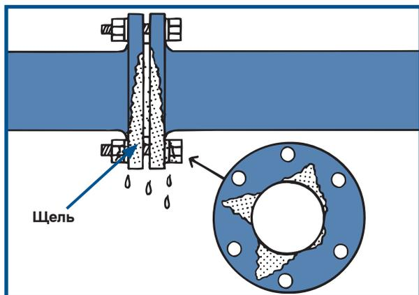
Рис. 6. Щелевая коррозия
