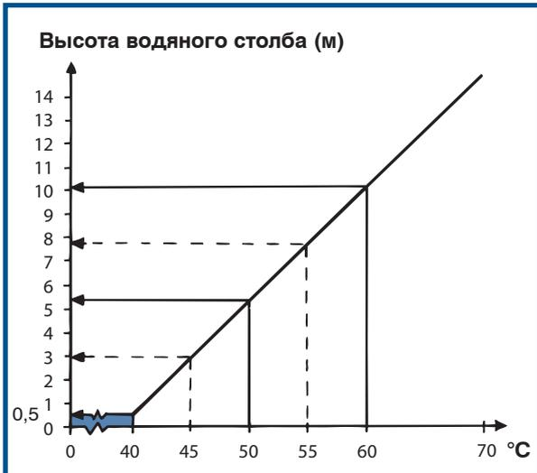
Рис. 26. Диаграмма зависимости высоты водяного столба, на которой следует устанавливать электродвигатели моделей MS 4000 и MS 6000, от температуры рабочей жидкости
