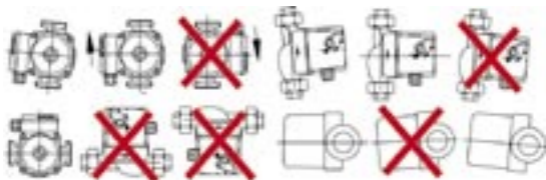
Допустимые варианты установки циркуляционных насосов Grundfos
